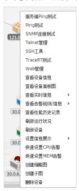
服务端 PING 测试:由 IT 管家服务器发起 PING 指令,对目标设备进行 PING 测试。软件将打开新的窗口进行 PING 的测试。
