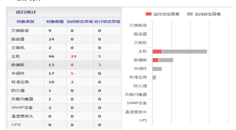
如图所示,统计的对象类别包括:交换路由、路由器、交换机、主机、数据库、中间件、标准应用、防火墙、负载均衡器、SNMP设备、温湿度探头、UPS。统计的信息包括:对象类别、对象数量、访问状态异常、运行状态异常。
