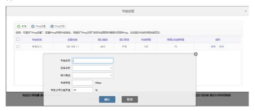
如上图所示,专线名称填写相应的专线辨别名称,设备名称填写连接线路的相应设备,端口描述填写所连线路的端口,专线带宽填写运营商分配的互联网带宽。带宽占用比越界值根据实际情况填写相应百分比。
